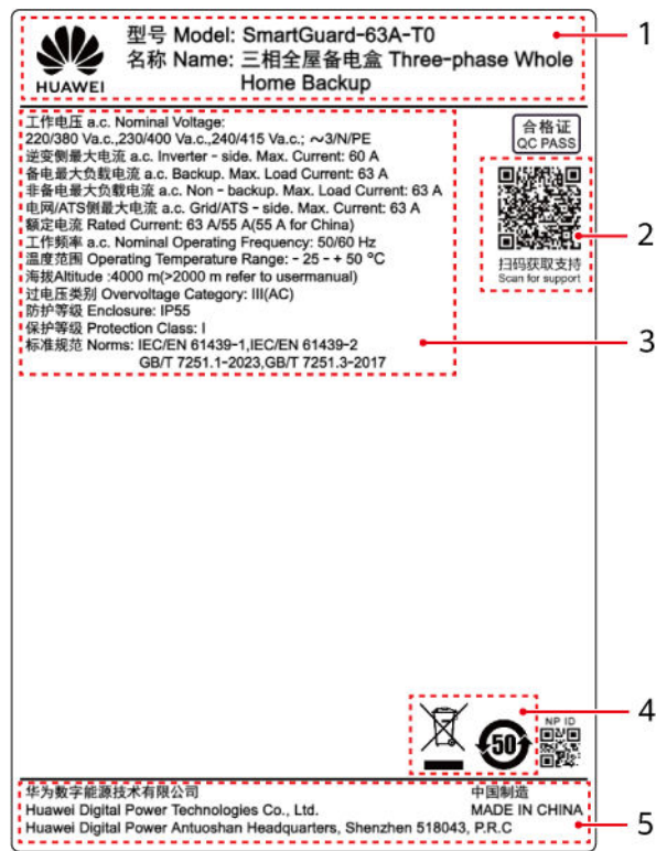
Abbildung 2-12 Bezeichnungsschild (SmartGuard-63A-T0 als Beispiel)
