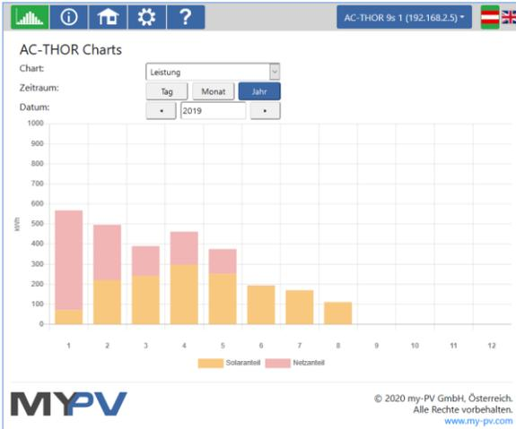
Orange Balken zeigen den Energieanteil der aus der Photovoltaik stammt, rote Balken den Anteil der optionalen Temperatursicherung.
