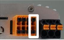
Diese Ansteuerung ist unabhängig von der gewählten Betriebsart, ausgenommen M8 am einphasigen AC•THOR. Ist ein PWM Signal vorhanden, so erfolgt auch die Übersteuerung aller anderen Steuersignale die möglicherweise über ein Netzwerk verfügbar wären. Ist am AC•THOR der Temperatur-Sicherstellungsbetrieb eingestellt, so bleibt dieser aber gültig.
